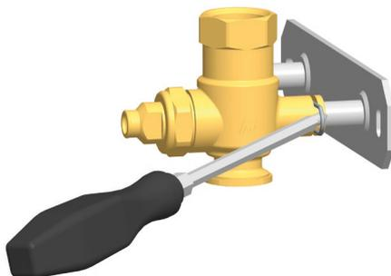
Per rimuovere il set di caricamento caldaia dal suo supporto, tirare con un cacciavite verso lateralmente i fermagli, facendoli fuoriuscire. Il set di caricamento caldaia può essere estratto frontalmente (attenzione alle tubazioni!).
