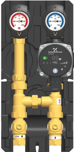
K36 sistema di caricamento della caldaia per l'innalzamento della temperatura nel ritorno in caldaie a olio e combustibile solido, impianti di combustione a legna nonché di riscaldamento a camino o a stufa
