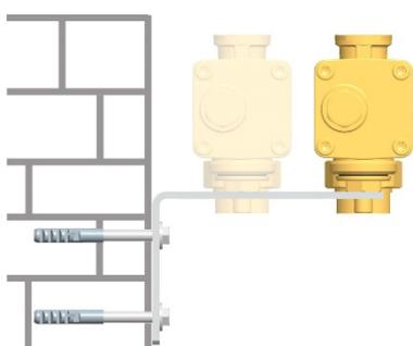
Se possibile, scegliere i fori di fissaggio più lontani rispetto al muro.
