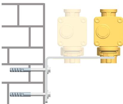
Falls möglich, wählen Sie die Befestigungslöcher, die am weitesten von der Wand entfernt sind. So können Sie die Isolierung einfacher montieren.
