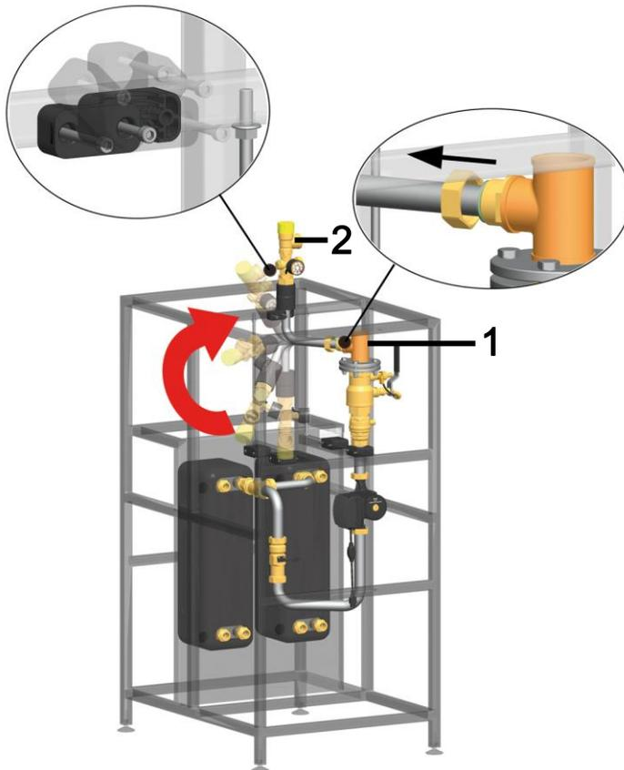
7. Die Sicherheitsgruppe ist zum Schutz vor Beschädigung werkseitig in der Station montiert.
