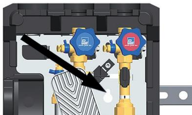
8. Hängen Sie die erste Station auf die Schraube, sodass sie oben durch die Aufnahmen im Halteblech greift. Sichern Sie sie mit einer Unterlegscheibe und Mutter.
