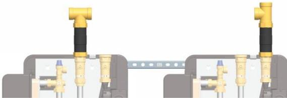
10. Schrauben Sie jeweils ein T-Stück auf die kurzen Rohre. Je nach Rohrführung können die T-Stücke beliebig montiert werden (Abgang seitlich oder nach oben).
