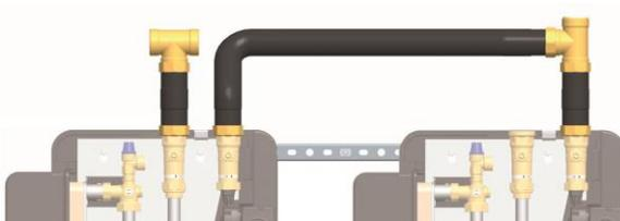
11. Schrauben Sie ein dreifach gebogenes Rohr am T-Stück der rechten Station und am Rücklauf der linken Station fest.
