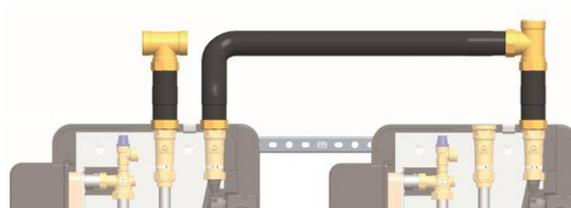
11. Atornille un tubo de triple curvatura a la pieza en T de la estación derecha y el otro al retorno de la estación izquierda.
