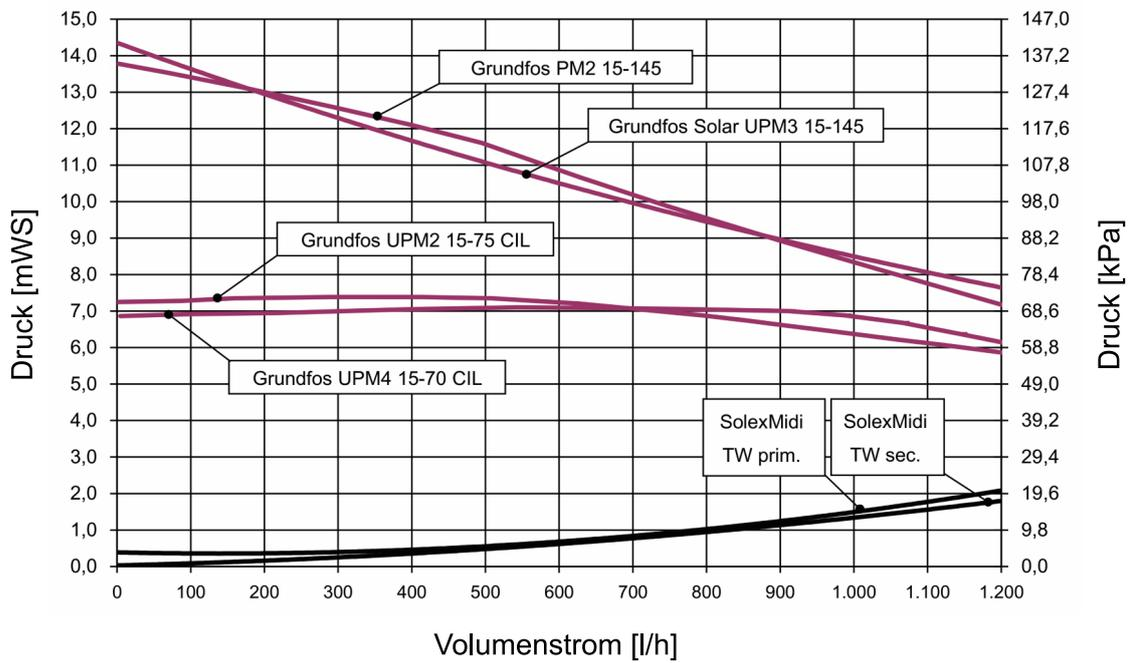
7.4 Druckverlust- und Pumpenkennlinien SolexMaxi TW
