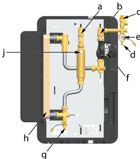
8. Schließen Sie den Entleerhahn [g] bei laufender Befüllpumpe und erhöhen Sie den Anlagendruck auf ca. 5 bar. Der Anlagendruck kann am Manometer [e] abgelesen werden.
