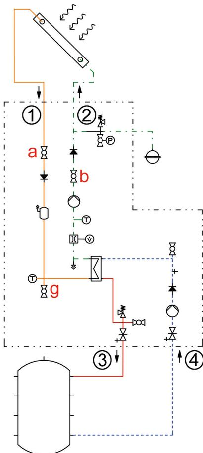
1. Schließen Sie die Kugelhähne [a|b] und lassen Sie die Solarflüssigkeit am KFE-Hahn [g] ab. Achten Sie darauf, dass die Solarflüssigkeit in einem hitzebeständigen Behälter aufgefangen wird.
