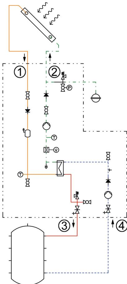
Die Verschraubungen der SolexMidi sind primär als  $\frac{3}{4}$ " Innengewinde und sekundär als 1" Außengewinde ausgeführt.
