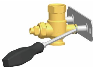
Pour retirer le kit de chargement chaudière de la console murale, appuyez sur les clips à ressort à l'aide d'un tournevis pour les faire sortir latéralement.
