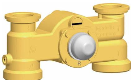
Se la tacca della vite bypass è in posizione orizzontale, il bypass è completamente aperto. Il massimo flusso in volume scorre dal ritorno nella mandata. Questa impostazione è necessaria per riscaldamenti a pannelli radianti laddove sia necessaria una grossa quantità di acqua in circolazione. Tramite il bypass la temperatura di mandata viene ridotta, influenzando negativamente sulle prestazioni del regolatore.
