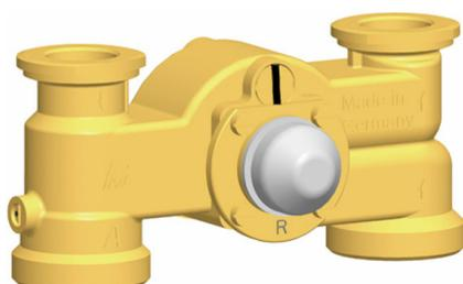
Se la tacca della vite bypass è in posizione verticale, il bypass è chiuso (normale funzionamento).
