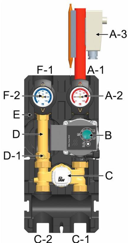
1. Estrarre le maniglie di termometro (A-2, F-2) e rimuovere il guscio termoisolante anteriore del HeatBloC®.
