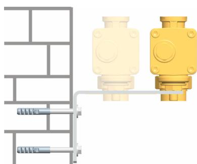
Se possibile, scegliere i fori di fissaggio più lontani rispetto al muro. In tal modo è possibile montare facilmente l'isolamento del collettore modulare.
