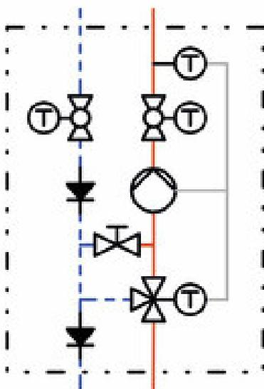
**Circuito di regolazione a valore costante 20-50 °C con valvola miscelatrice a 3 vie e bypass 0-50%**
