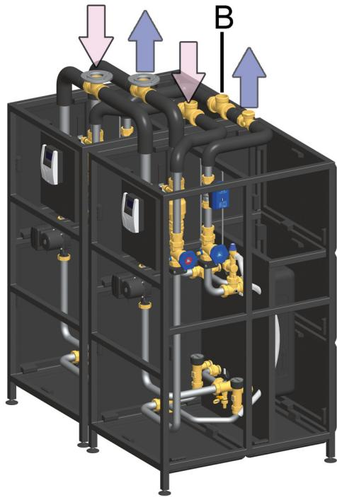
2. Montare il set di circolazione sul collegamento. Prestare attenzione alla direzione di flusso attraverso la valvola antitermosifone.
