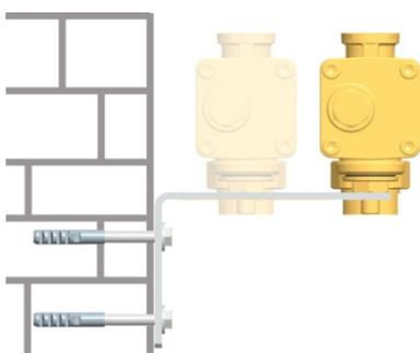
Falls möglich, wählen Sie die Befestigungslöcher, die am weitesten von der Wand entfernt sind. So können Sie die Isolierung des Modulverteilers einfacher montieren.
