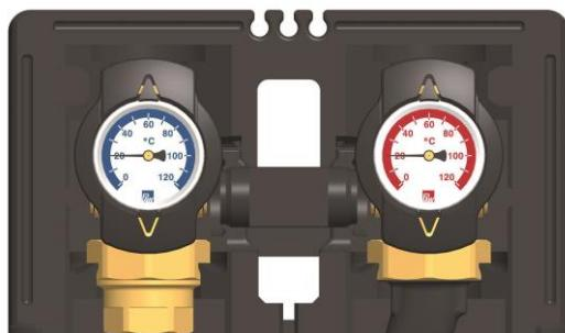
4. Las llaves esféricas térmicas están equipadas respectivamente con 2 manguitos G1/4" cerrados con tapones. Estos manguitos pueden utilizarse para el montaje de los sensores de temperatura del calorímetro.
