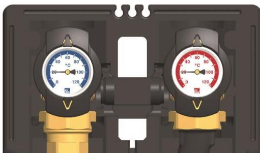
4. Le valvole a sfera dei termometri hanno ciascuna due dadi da  $\frac{1}{4}$ ", chiusi dai dei tappi. Questi manicotti possono essere utilizzati per montare i sensori di temperatura del contatore di portata.
