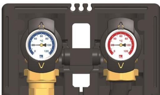
4. Die Thermometer-Kugelhähne verfügen jeweils über 2 Muffen G1/4", die mit Stopfen verschlossen sind. Diese Muffen können für die Montage der WMZ-Temperaturfühler verwendet werden.
