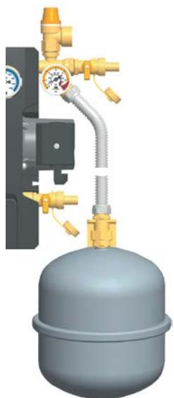
1. Fije el tubo corrugado de acero inoxidable al equipo de seguridad. No olvida insertar la junta.
