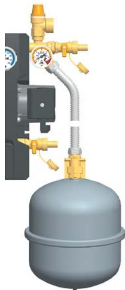
1. Raccordez le tuyau ondulé en inox au groupe de sécurité.
