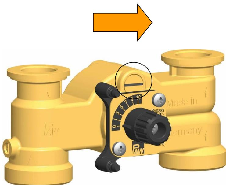
Si la fente de la vis du bypass est en position horizontale, le bypass est entièrement ouvert.
