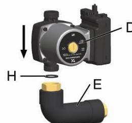
7. Raccordez le tube en acier inoxydable [E] ou [C] avec la pompe. Pour cela, utilisez un des joints EPDM noirs [H].
