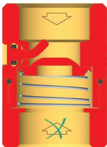
La marca debe señalar hacia "Z" durante el funcionamiento.
