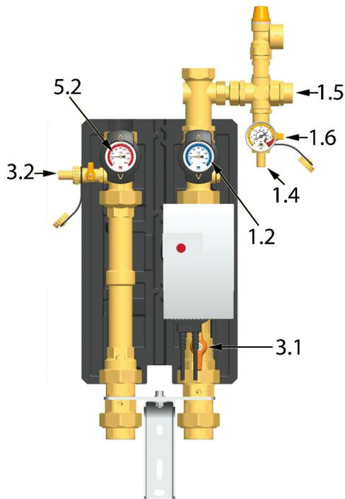
1. Mettez les deux clapets anti-thermosiphon en position de fonctionnement sur "Z" et ouvrez les vannes à sphère dans le départ et le retour [1.2|5.2].
