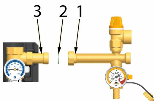
3. **Seulement pour la variante avec Wilo Maxo / Grundfos Solar PML :** Montez le groupe de sécurité joint pour le complément et avant de la mise en service. Pour ce faire, vissez l'écrou-raccord (1) du renfort de sécurité sur l'entretoise (3) en utilisant le joint correspondant (2).
