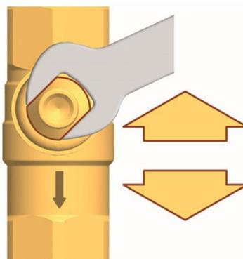
Clapet anti-thermosiphon hors service, **passage dans les deux sens.**
