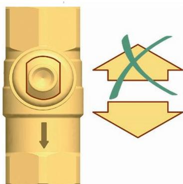
Clapet anti-thermosiphon en service, **passage uniquement dans le sens de circulation.**
