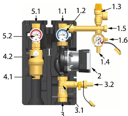
Le circuit solaire est rincé dans le sens de circulation du fluide solaire.
