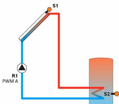
4. Raccordez les capteurs au régulateur : sonde de capteur à S1, sonde de ballon de stockage à S2.
