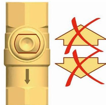
Kugelhahn geschlossen, **keine Durchströmung.**
