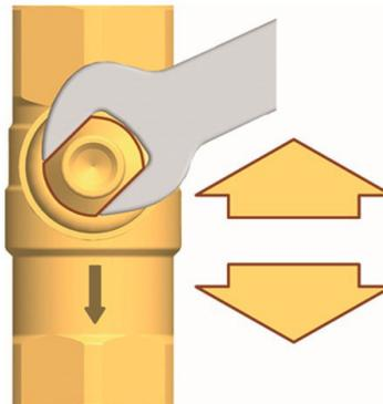
Schwerkraftbremse außer Betrieb, **Durchströmung in beide Richtungen.**
