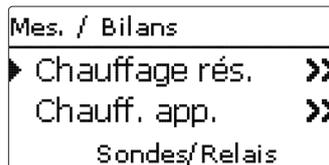
Ce menu indique également l'état actuel du chauffage du réservoir; celui de la circulation, de la désinfection, de la stratification du retour, les sondes et les relais utilisés ainsi que le compteur d'heures de fonctionnement.
