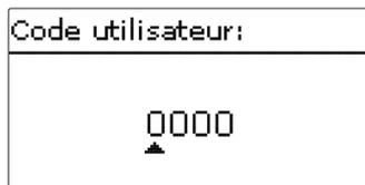
Chaque chiffre du code à 4 chiffres doit être saisi et confirmé un par un. Après avoir validé le dernier chiffre du code, le régulateur affichera le sous-menu précédent.
