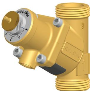
Für den hydraulischen Abgleich im Heizkreis. Für Radiatorheizkreise empfohlen. Mit Anschlussmöglichkeit für einen Stellantrieb (Anschluss M30 x 1,5) zur EnEV-konformen Abschaltung der Wärmeversorgung der Wohnung.
