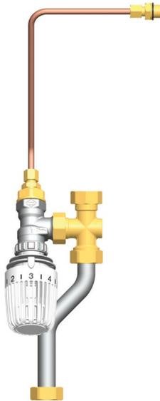
Die thermische Warmhaltung stellt einen Kurzschluss zwischen Vor- und Rücklaufleitung dar. Sobald die Temperatur in der Vorlaufleitung vom Wärmerezeuger unter die eingestellte Temperatur fällt (z.B. im Sommerbetrieb, wenn alle Heizkörper außer Betrieb sind), öffnet das Thermostatventil die Bypassleitung. Das Ventil bleibt so lange geöffnet, bis die eingestellte Temperatur am Ventil anliegt.
