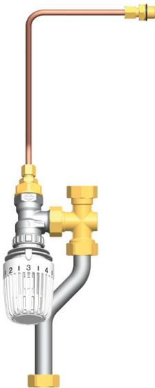
Die thermische Warmhaltung bildet einen temperaturgeregelten Kurzschluss für die Wärmeversorgungs-Leitungen. Sobald die eingestellte Temperatur am Thermostatkopf sinkt, öffnet das thermische Ventil. Aus dem Wärmeerzeuger-Vorlauf fließt warmes Wasser direkt in den Rücklauf, so lange bis die am Thermostatkopf eingestellte Temperatur wieder erreicht ist.
