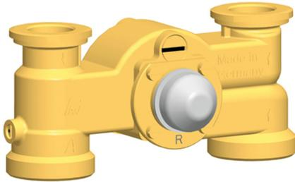
Wenn der Schlitz der Bypass-Schraube in waagerechter Position steht, ist der Bypass voll geöffnet. So strömt der größtmögliche Volumenstrom vom Rücklauf in den Vorlauf. Diese Einstellung ist ggf. bei Fußbodenheizungen notwendig, die eine sehr große Wassermenge benötigen. Durch den Bypass wird die Vorlauftemperatur gesenkt und das Regelverhalten ggf. negativ beeinflusst.
