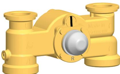
Wenn der Schlitz der Bypass-Schraube in senkrechter Position steht, ist der Bypass geschlossen (normaler Regelbetrieb).
