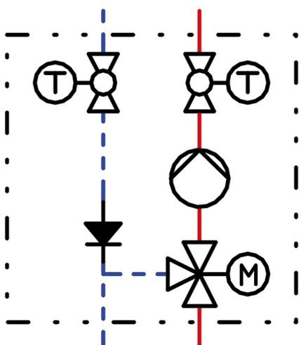
**K32 – HeatBloC® avec vanne mélangeuse à 3 voies**
