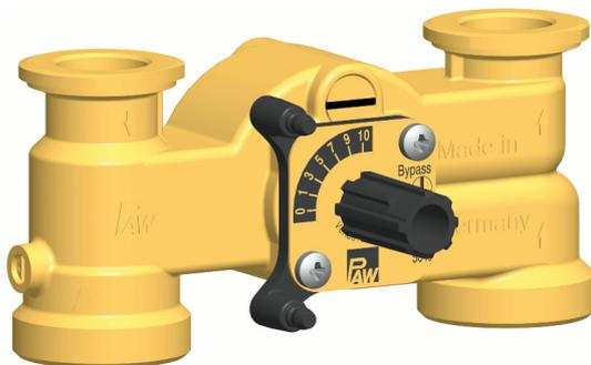
Cela permet un débit volumique maximal entre le retour et le départ. Ce réglage est éventuellement nécessaire pour les planchers chauffants nécessitant un débit très important de circulation d'eau. Le bypass entraîne une baisse de la température de départ et influence la régulation.
