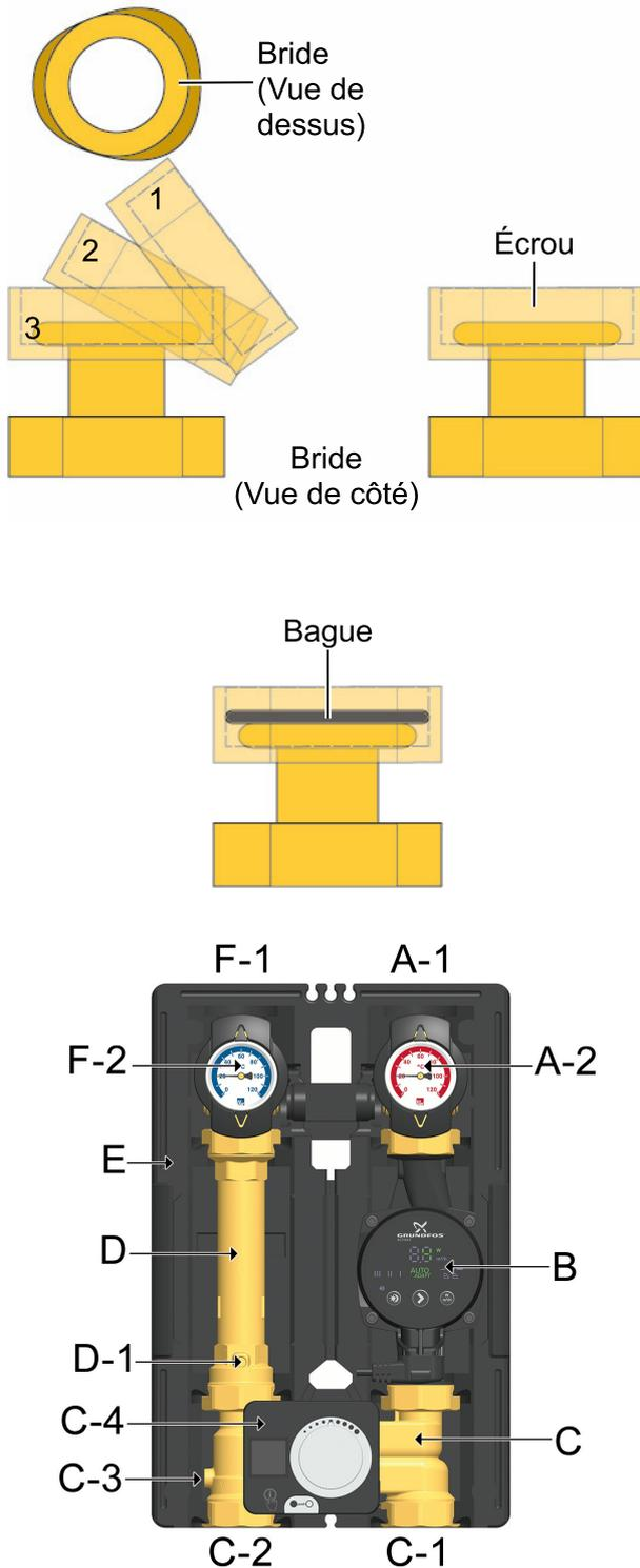
1. Retirez les poignées de thermomètre (A-2, F-2) et la coque isolante avant du HeatBloC®.
