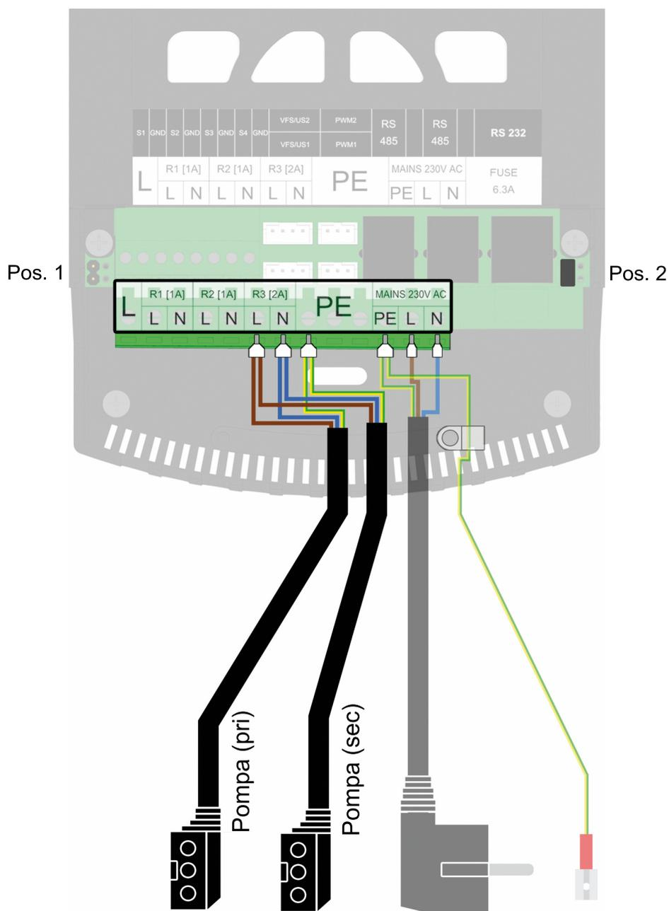
6. Per il primo e l'ultimo utente della comunicazione Modbus è necessario mettere i jumper in pos. 2 (vedi grafico in alto). inserire i jumper come segue:
