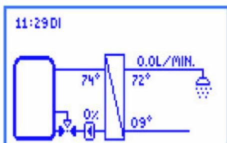
La funzione serve per migliorare la stratificazione di temperatura nell'accumulatore ed evitare una miscelazione. Poiché nel ritorno possono esserci temperature molto diverse (se ad esempio è presente una circolazione), esso viene collegato all'accumulatore con l'ausilio di una valvola a tre vie.
