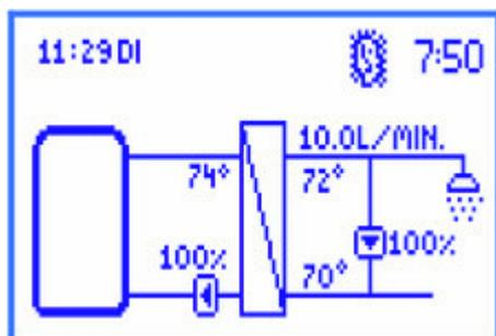
Impianti di acqua calda potabile di dimensioni maggiori vengono disinfettati termicamente per ammazzare germi pericolosi (ad esempio legionella) nel sistema. A tale scopo la stazione ACS istantanea può mettere a disposizione temperature maggiori di acqua calda.
