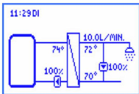
L'acqua potabile nella condotta di circolazione viene riscaldata alla temperatura nominale desiderata mediante una funzione di circolazione. La pompa di circolazione a tal fine prevista viene controllata dal regolatore mediante l'attacco 2 PWM.
