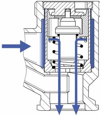
1. Wenn die Temperatur des Wassers im Kesselkreis niedriger ist als die Öffnungstemperatur des thermischen Regelventils, ist dieses Ventil geschlossen und somit auch der Weg zu den Verbrauchern. Das Wasser wird über den vollständig geöffneten Bypass im Kesselkreis „umgewälzt“.
