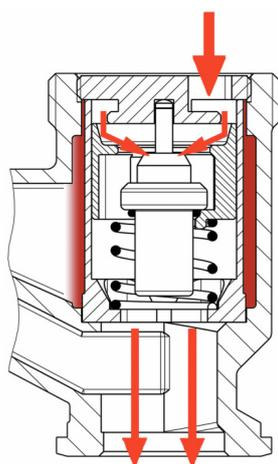
3. Mit steigender Temperatur aus dem Verbraucherrücklauf öffnet das thermische Regelventil den Weg zu den Verbrauchern vollständig. Die Temperatur des Kesselrücklaufs ist im Betrieb annähernd konstant (+/-3 K). So lange, bis der Pufferspeicher vollständig beladen ist.
