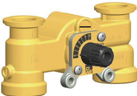
Wenn der Schlitz der Bypass-Schraube in waagerechter Position steht, ist der Bypass voll geöffnet. So strömt der größtmögliche Volumenstrom vom Rücklauf in den Vorlauf.
