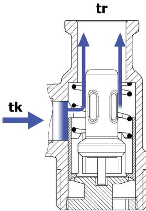
Das thermische Ventil verschließt den Weg zum Speicher, solange das Wasser im Kesselkreis [tk] kälter ist als die Öffnungstemperatur des thermischen Ventils. Die Pumpe im Kesselladeset K36 wälzt das Wasser im Kesselkreis über den völlig geöffneten automatischen Bypass um.
