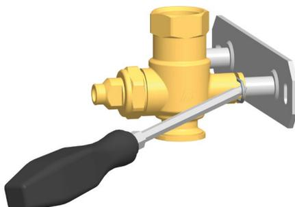
Um das Kesselladeset vom Halter abzunehmen, drücken Sie die Clip-Federn mit einem Schraubendreher seitlich heraus. Das Kesselladeset kann nach vorne abgezogen werden (Verrohrung beachten!).
