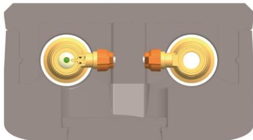
3. Les poignées des vannes à sphère pour pompes doivent être tournées vers l'intérieur pour que l'isolation avant puisse être fermée (voir figure à gauche).
