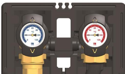
5. Die Thermometer-Kugelhähne verfügen jeweils über 2 Muffen G $\frac{1}{4}$ ", die mit Stopfen verschlossen sind. Diese Muffen können für die Montage der WMZ-Temperaturfühler verwendet werden.
