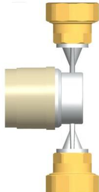
1. Smontare prima i giunti dal tubo di raccordo e montarli al contatore di calore.
