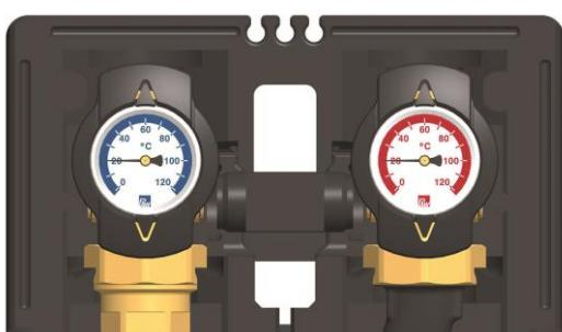
5. Les vannes à sphère avec thermomètre sont équipées respectivement de 2 manchons G1/4" fermés par des bouchons. Ces manchons peuvent être utilisés pour le montage des sondes de température du calorimètre.
