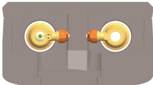
3. Gire las manetas de las llaves esféricas para bomba hacia dentro para poder cerrar el aislamiento delantero (véase ilustración izquierda).
