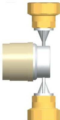
1. Primero desmonte las piezas de unión del tubo de ajuste e instale estos al calorímetro.
