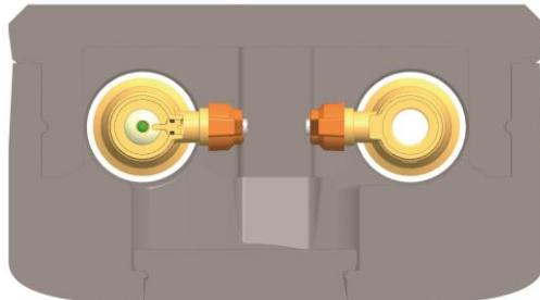
3. Ruotare le maniglie delle valvole a sfera per pompe verso l'interno per poter chiudere l'isolamento frontale (vedi l'illustrazione a sinistra).
