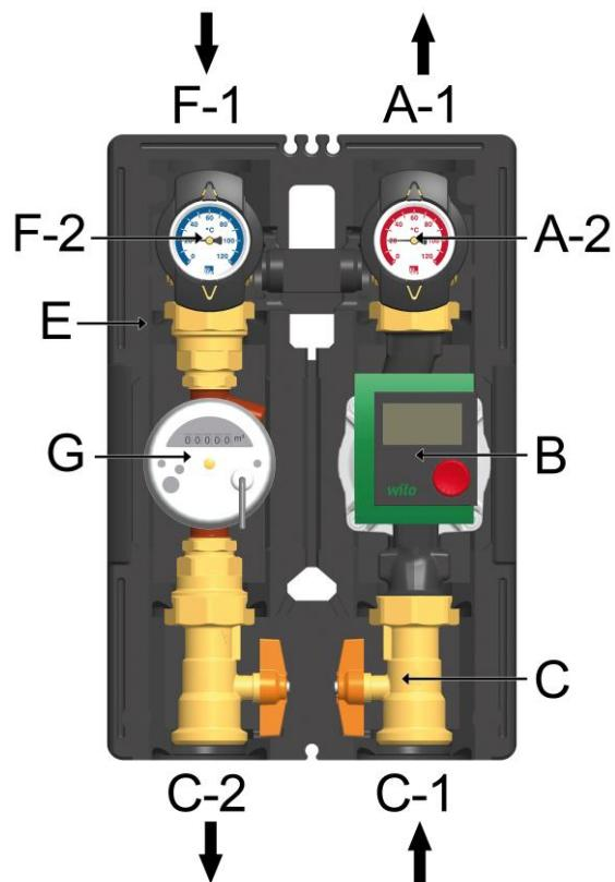
Die Montage der Einbaustrecke erfolgt in den Heizungsrücklauf. Der Vorlauffühler für die Wärmemengenzählung kann mit einem der beigefügten Reduzierstücke in den Vorlauf-Thermo-Kugelhahn [A-2] oder in bauseitige Anschlüsse montiert werden. Die Fühler sowie der Wärmemengenzähler gehören nicht zum Lieferumfang! Für die Demontage der Isolierung beachten Sie die Anleitung zum Heizkreis.
