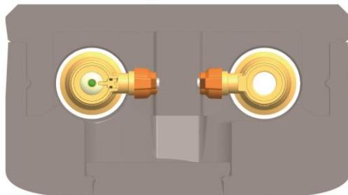
3. Die Griffe der Pumpenkugelhähne müssen nach innen gedreht werden, damit die vordere Isolierung geschlossen werden kann (siehe Abbildung links).
