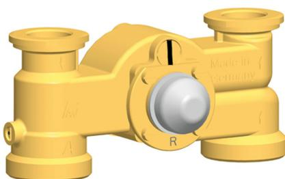
Wenn der Schlitz der Bypass-Schraube in senkrechter Position steht, ist der Bypass geschlossen (normaler Regelbetrieb).
