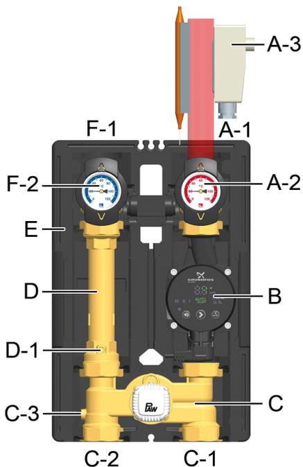
1. Nehmen Sie die Thermometergriffe (A-2, F-2) heraus und ziehen Sie die vordere Isolierschale des HeatBloC®s ab.
