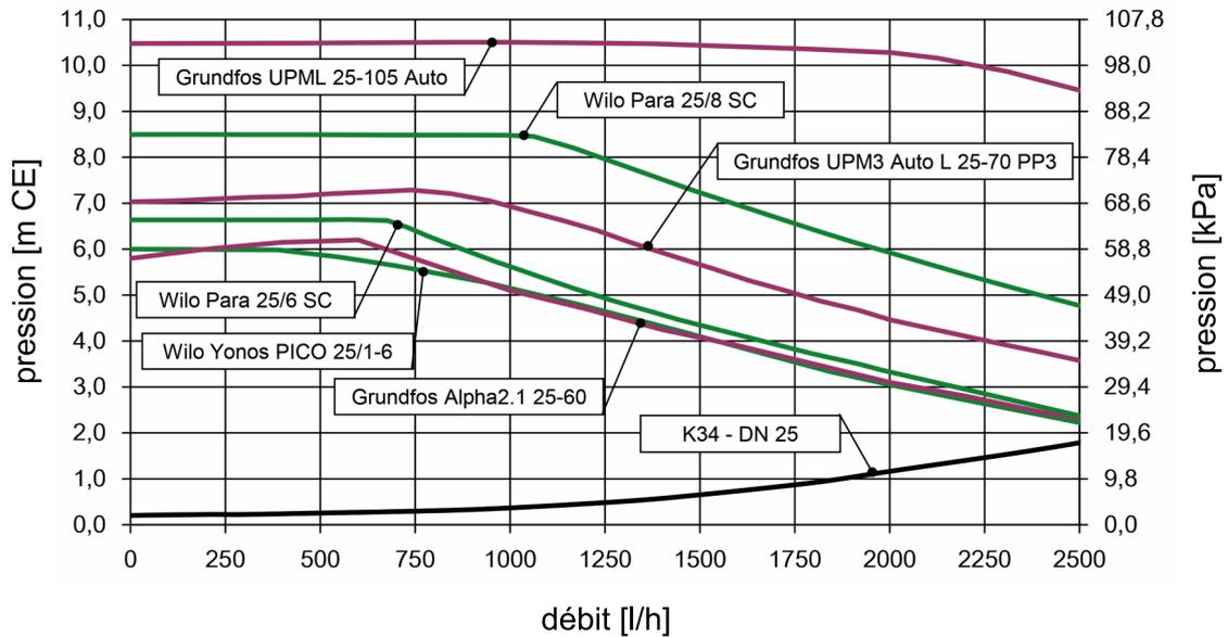
6.2 Courbes caractéristiques de perte de charge et des pompes DN 32
