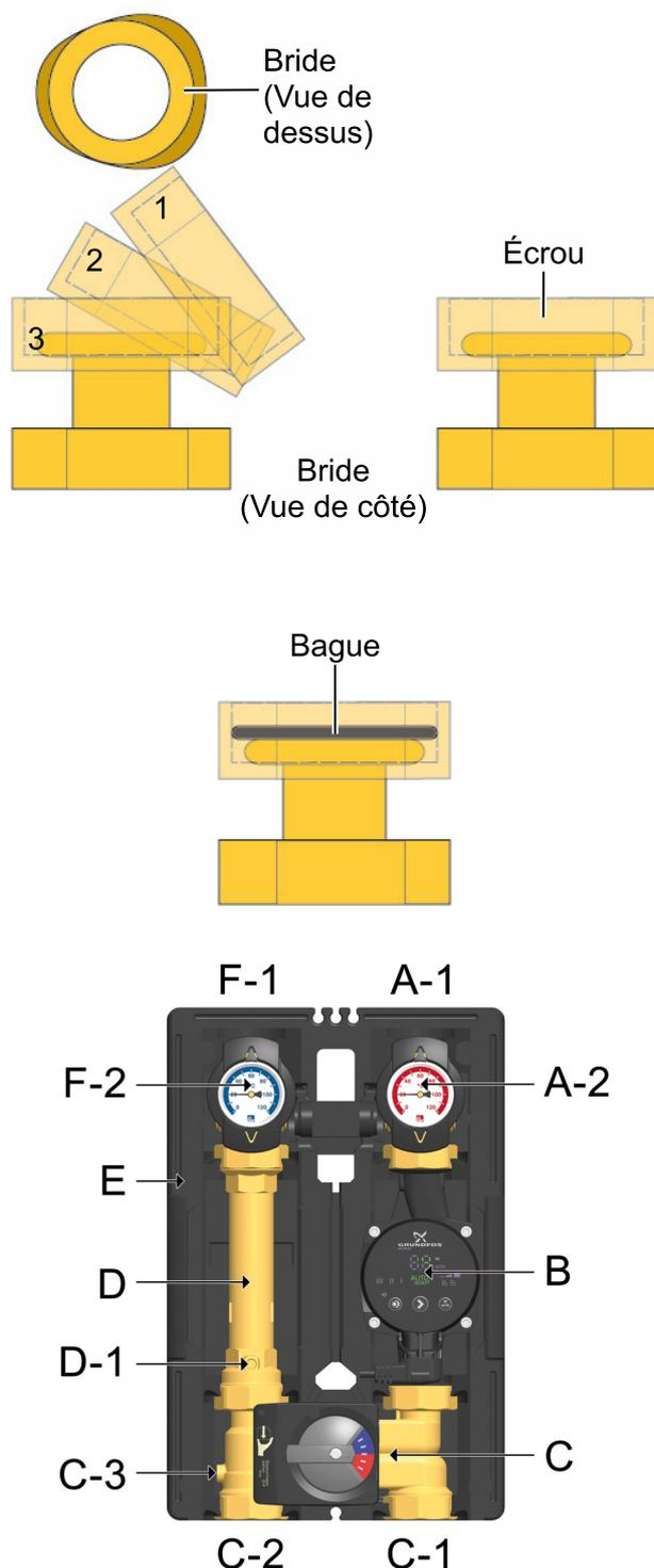
1. Retirez les poignées de thermomètre (A-2, F-2) et la coque isolante avant du HeatBloC®.
