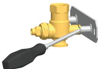
Pour retirer le kit de chargement chaudière de la console murale, appuyez sur les clips à ressort à l'aide d'un tournevis pour les faire sortir latéralement.
