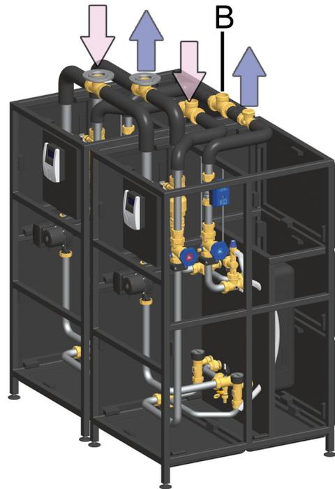
2. Montieren Sie das Zirkulationsset an den Anschluss. Achten Sie auf die Durchflussrichtung durch die Schwerkraftbremse.
