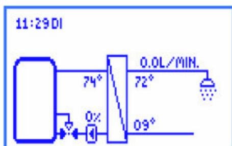
La fonction sert à améliorer la stratification dans le ballon et à éviter un mélange. En raison des températures très différentes qui peuvent exister dans le retour (dans le cas d'une circulation par exemple), ce dernier est raccordé au ballon à l'aide d'une vanne à trois voies.
