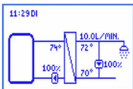
A l'aide de la fonction de circulation, l'eau potable est chauffée à la température de consigne souhaitée dans la ligne de circulation. La pompe de circulation prévue à cet effet est commandée par le régulateur via le raccord MLI 2.
