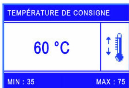
Cet élément de menu vous permet d'effectuer les réglages de température pour la préparation d'eau chaude sanitaire.
