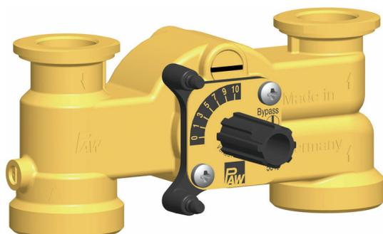
Se la tacca della vite bypass è in posizione orizzontale, il bypass è completamente aperto. Il massimo flusso in volume scorre dal ritorno nella mandata. Questa impostazione è necessaria per riscaldamenti a pannelli radianti laddove sia necessaria una grossa quantità di acqua in circolazione. Tramite il bypass la temperatura di mandata viene ridotta, influenzando sulle prestazioni del regolatore.
