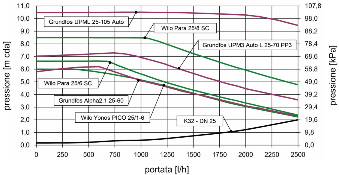
6.2 Perdita di pressione e curve caratteristiche della pompa DN 32
