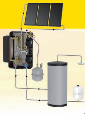
SolexMaxi TW avec vase d'expansion à membrane et groupe de sécurité pour eau sanitaire
