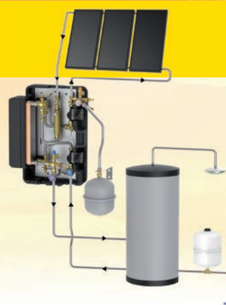
SolexMidi TW avec vase d'expansion à membrane et groupe de sécurité pour eau sanitaire
