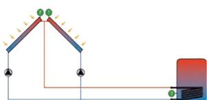
2 Kollektorfelder, interner Wärmetauscher, Pumpenlogik
