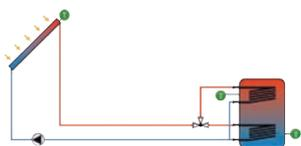
Interner Wärmetauscher, Zonenbeladung, Ventillogik
