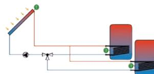
2 Speicher, interner Wärmetauscher, Ventillogik
