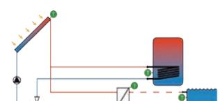
Speicher und Schwimmbad, autarker Betrieb des externen Wärmetauschers, Ventillogik
