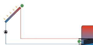
Interner Wärmetauscher, Pumpenlogik, Heizungsrücklaufanhebung
