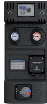
MC43 Konstantwert-Regelkreis, 3-Wege-Mischer mit Bypass 0-50%
