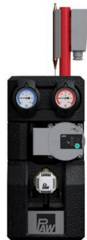
K33 Konstantwert-Regelkreis, 3-Wege-Mischer mit Bypass 0-50 %
