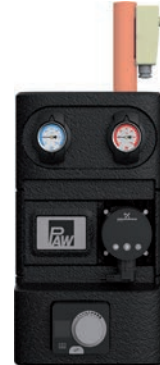
K33R Konstantwert-Regelkreis, elektronisch, 3-Wege-Mischer mit Bypass 0-50 %
