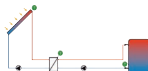
Externer Wärmetauscher, Pumpenlogik (1 x E13170 zusätzlich erforderlich)
